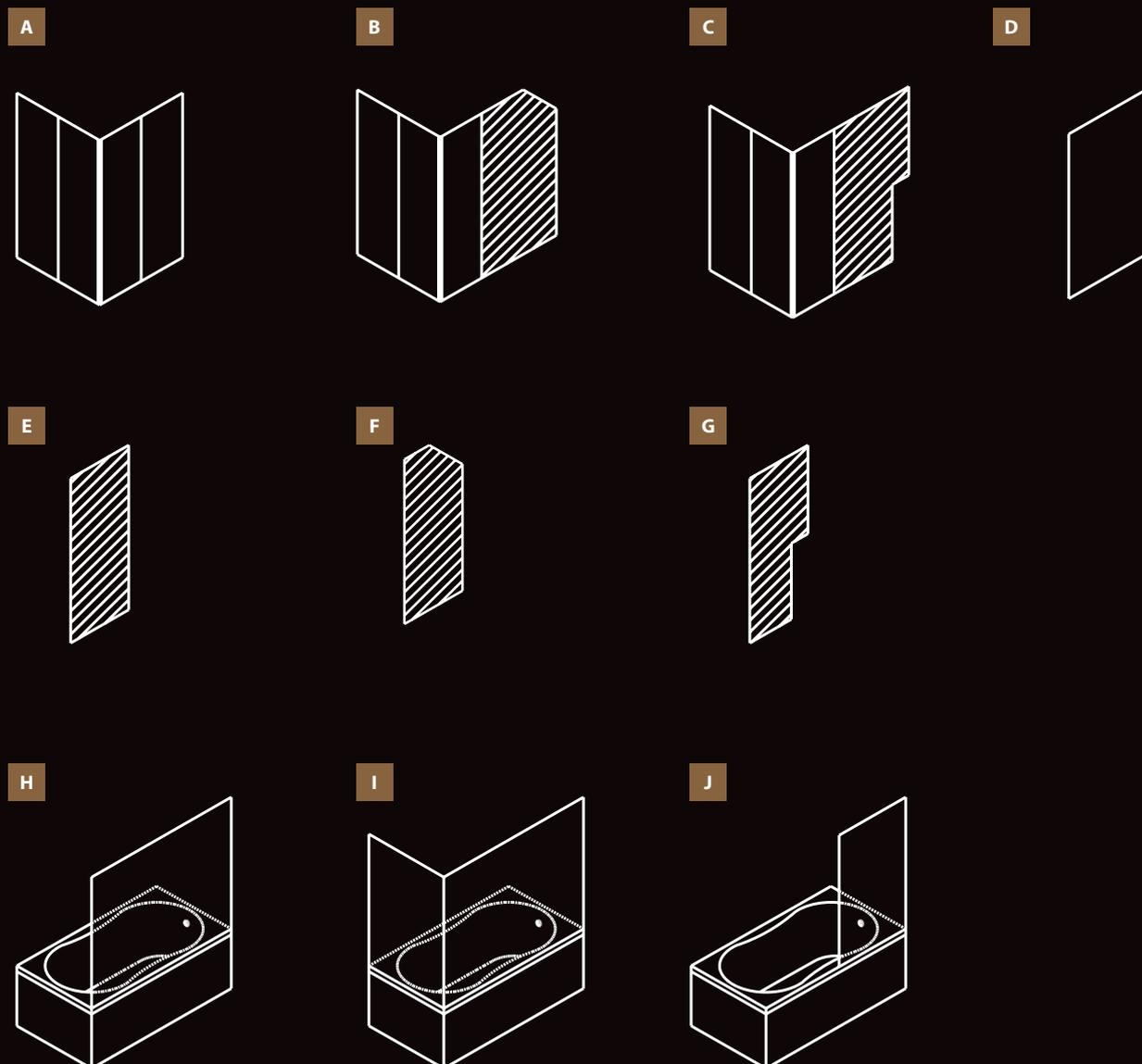
1. Schéma A montre les possibilités de modification de la largeur et de la hauteur d'une paroi douche fermée standard.
